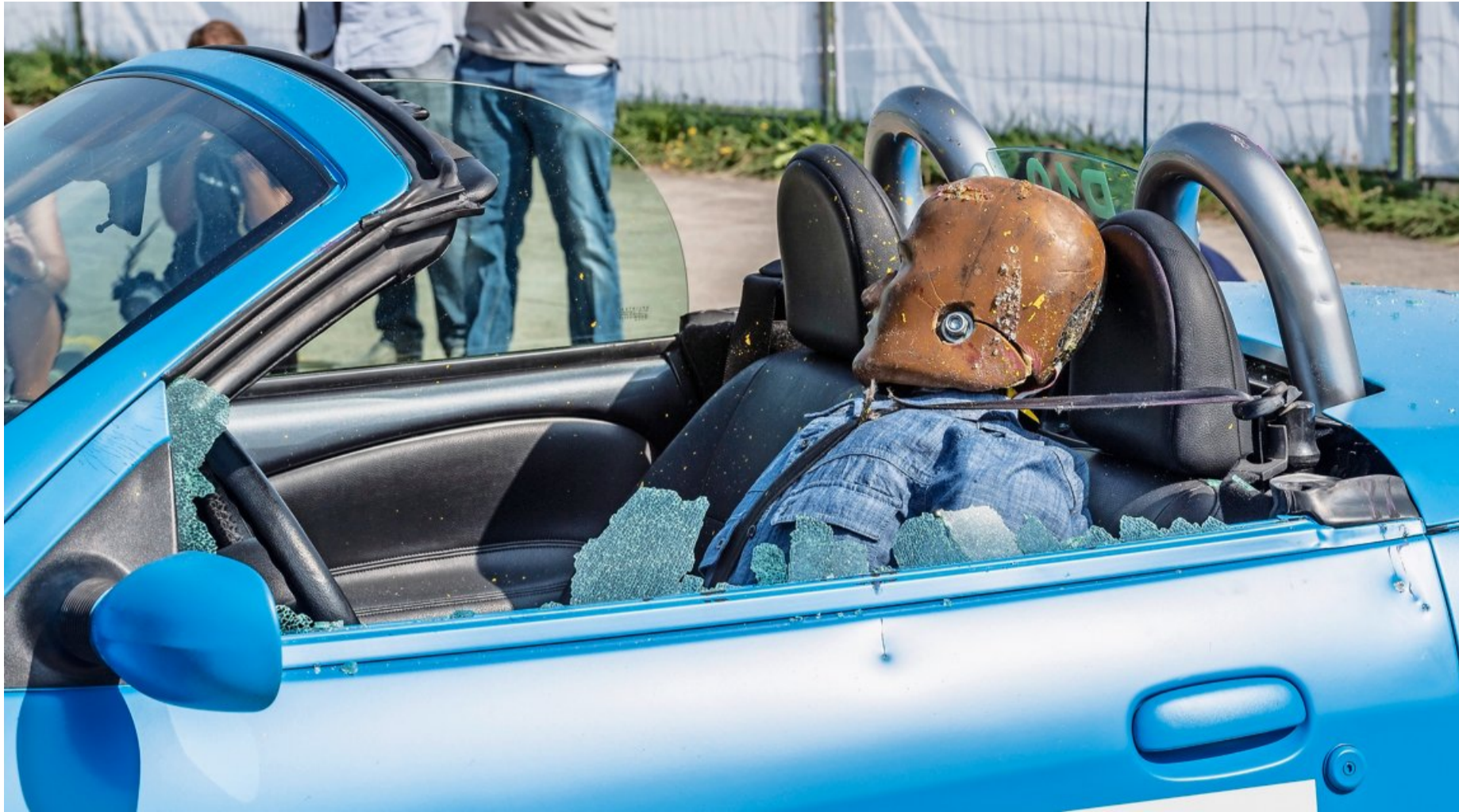
Beim Crashtest in Dübendorf ist der Dummy durch den Aufschlag einer Drohne erheblich beschädigt worden.
